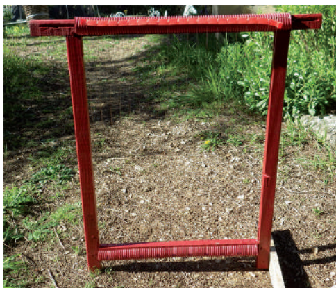
Harpe électrique anti-frelons asiatiques.
